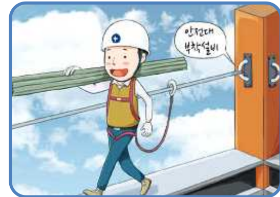
6 안전대 착용 시 안전대 부착설비 설치
